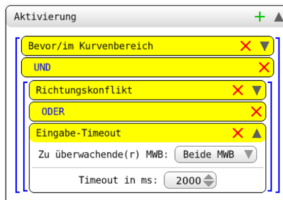
Abbildung B.2: Eine Aktivierungsbedingung mit den Operatoren UND sowie ODER im Automaten-GUI
