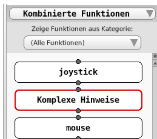
Abbildung C.15: Existierende Automaten stehen als kombinierte Funktionen in neuen Automaten zur Verfügung.
